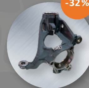
Schwenklager V3 Bionik Steering Knuckle V3 | Bionic Gewicht / Weight 2,99 kg, -32%
